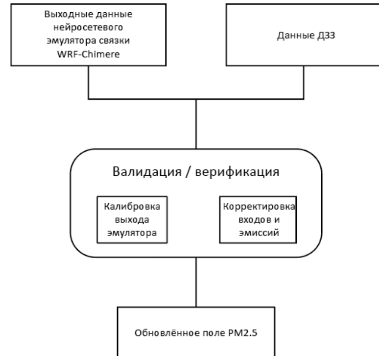
Рис. 3. Схема объединения быстрого прогноза нейросети с уточнением по спутниковым данным
