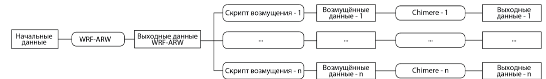
Рис. 1. Схема генерации ансамбля обучающей выборки из n элементов (переменная V )
